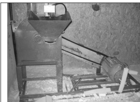
Figura 16 - Picadeira de capim adaptada para espuma
