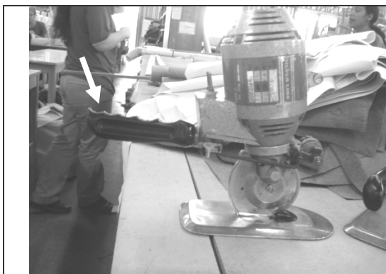
Figura 48 - Cabo da máquina de corte invertido
