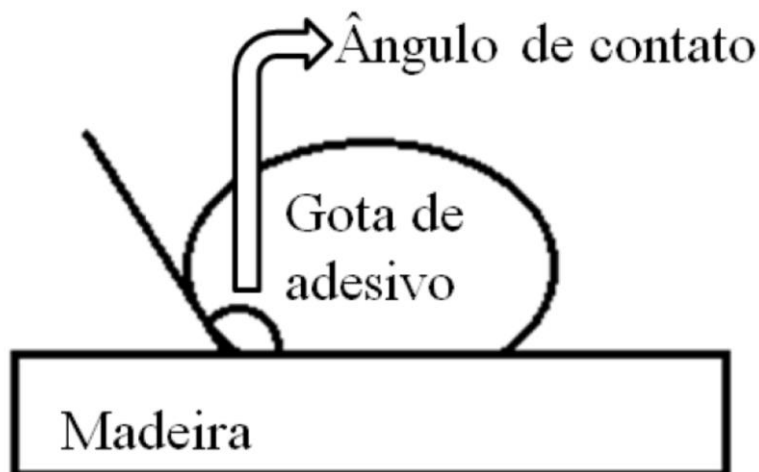
Figura 1. Esquema do ângulo de contato formado pelo líquido sobre a superfície da madeira. Fonte: CÉSAR, 2011.
