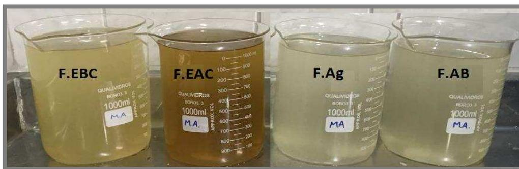
Figura 23. Filtrados após estágios de branqueamento realizados com os diferentes tipos de água de lavagem (EBC: efluente de baixa carga orgânica; EAC: efluente de alta carga orgânica; Ag: água deionizada; AB: água branca da máquina de secagem)
