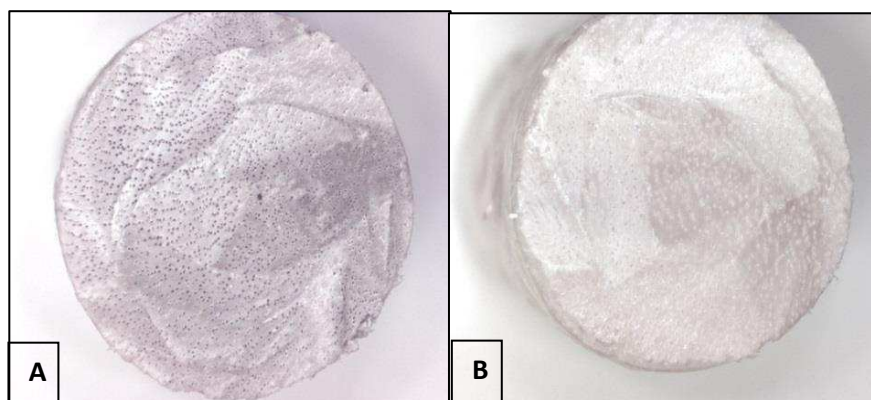
Figura 3 – Amostras de madeira evidenciando: A: Alburno; B: Cerne.
