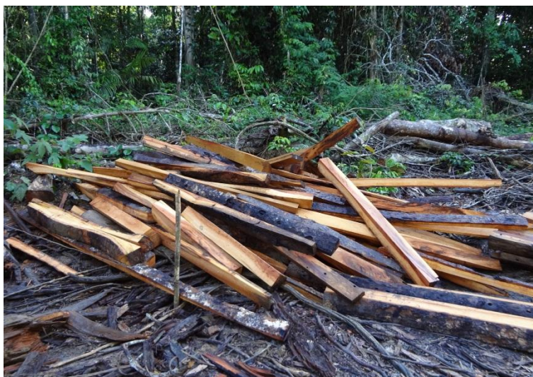
Figura 21. Aparas e costaneiras geradas após o desdobro dos toretes.
