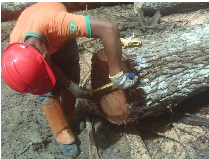
Figura 13. Manejador executando a cubagem rigorosa em um torete de maçaranduba.
