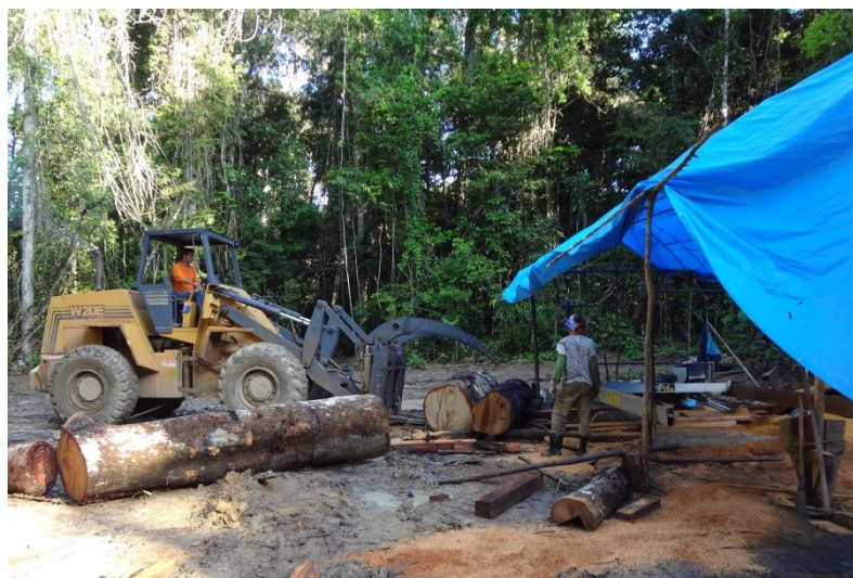
Figura 17. Carregadeira apoiando ao beneficiamento dos toretes.
