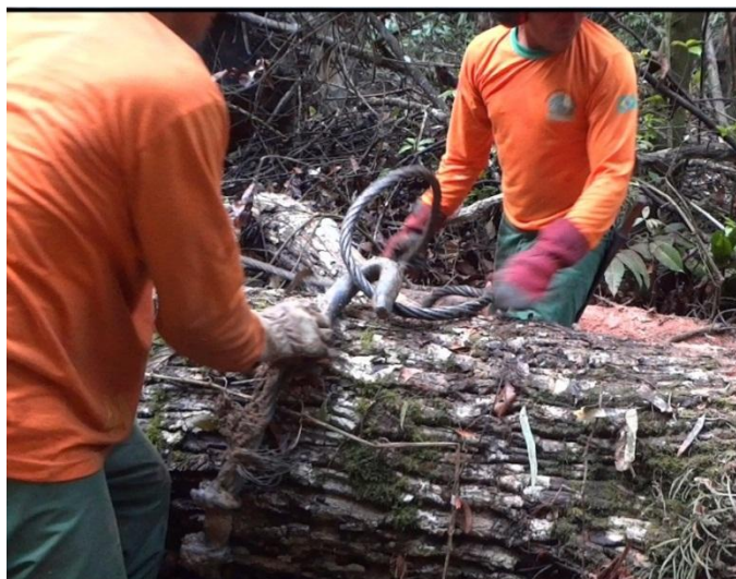
Figura 9. “Enlaçamento” do cabo da skidder em um resíduo de maçaranduba.
