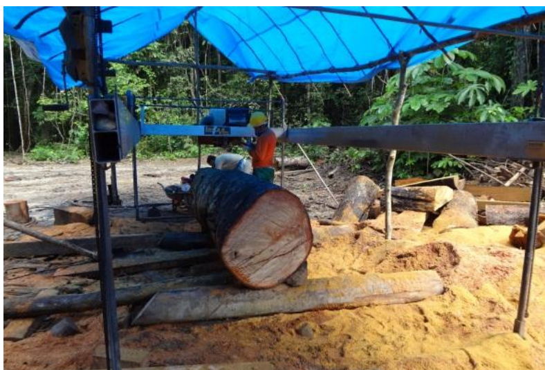
Figura 16. Serraria portátil instalada no pátio de estocagem.
