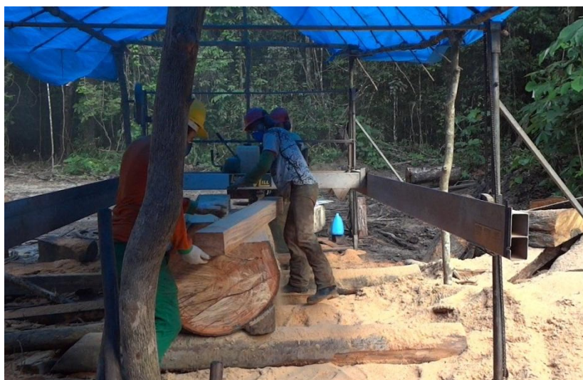
Figura 19. Beneficiamento de um torete de fava-timborana, com blocos de 15 cm x 13 cm.
