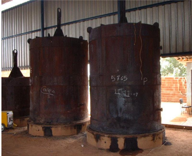
Figura 2 - Forno container na estação de pré-pirólise
