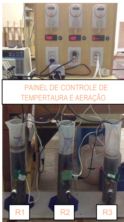
Figura 10. Biorreatores e sistema de controle automático.
