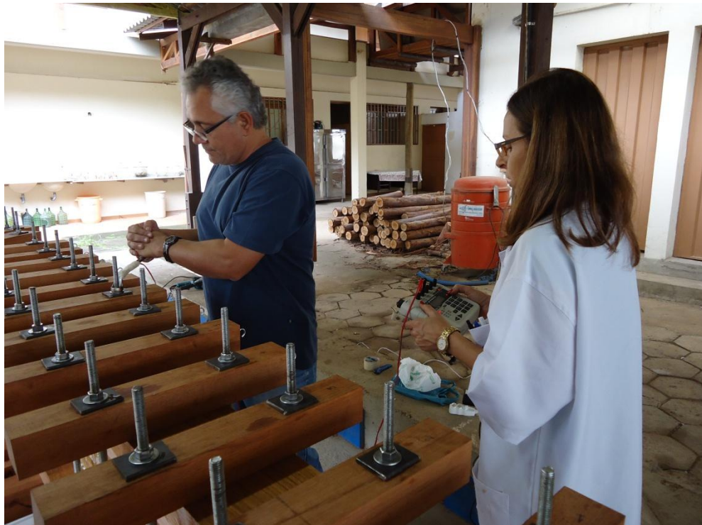
Figura 9 – Aperto dos parafusos com controle da aplicação de pressão.
