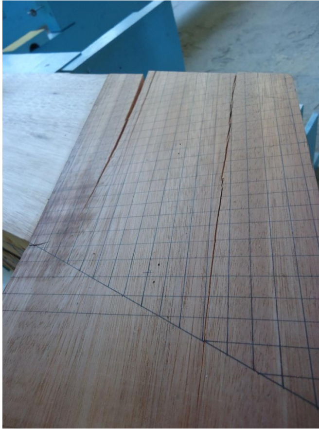
Figura 44 - Detalhe da ruptura ocorrida na região do nó B da estrutura R3.
