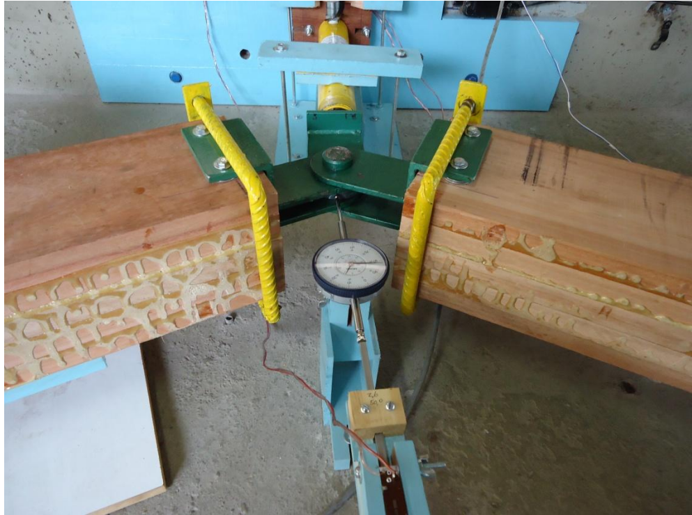
Figura 15 – Detalhe da rótula metálica da cumeeira e posicionamento do relógio.
