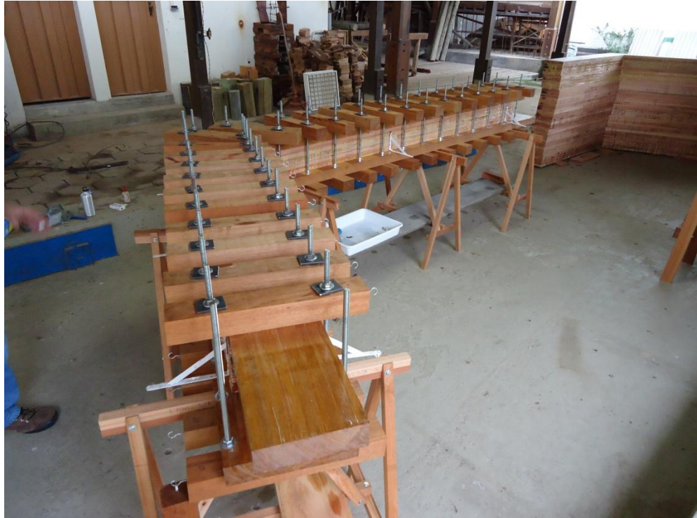
Figura 10 – Estrutura sob pressão no gabarito.
