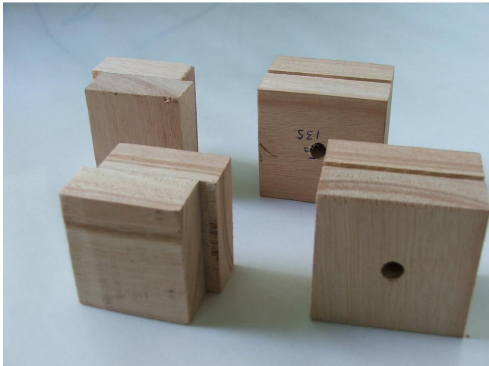
Figura 34 – Corpos de prova a serem ensaiados ao cisalhamento na compressão e na torção.
