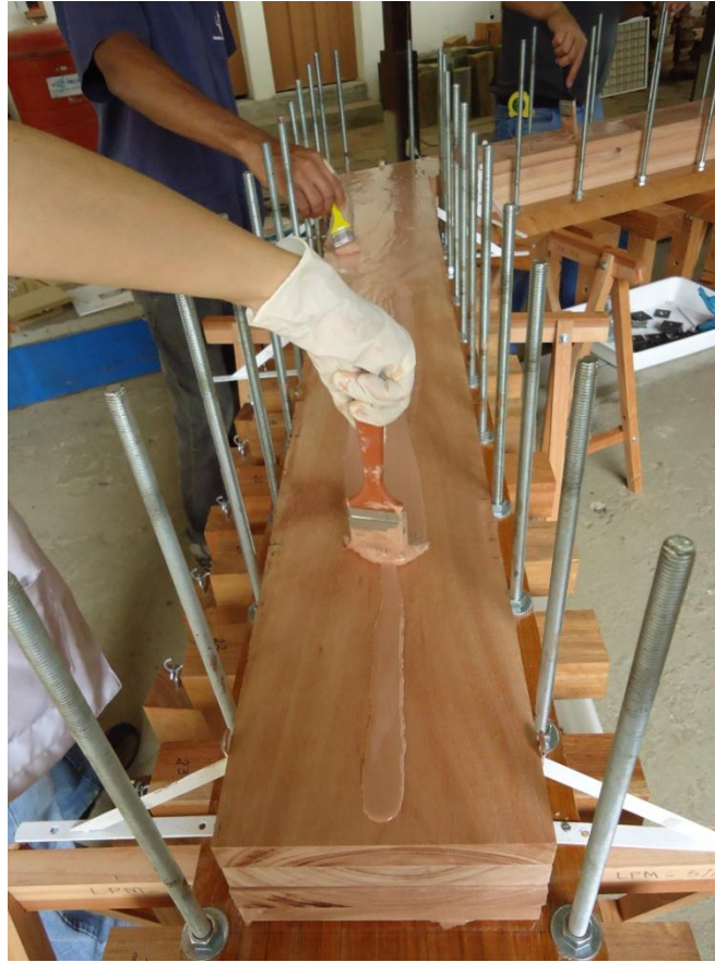
Figura 8 – Espalhamento do adesivo resorcinol formaldeído com pincel.
