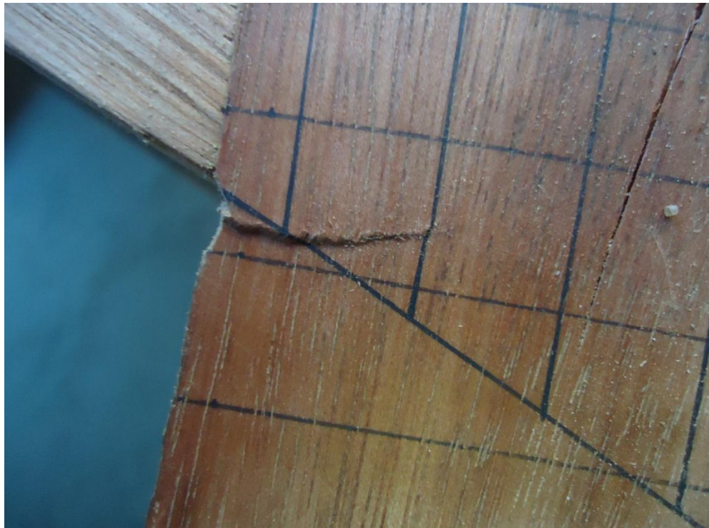
Figura 45 - Detalhe da fratura de compressão ocorrida no nó B da estrutura R3.
