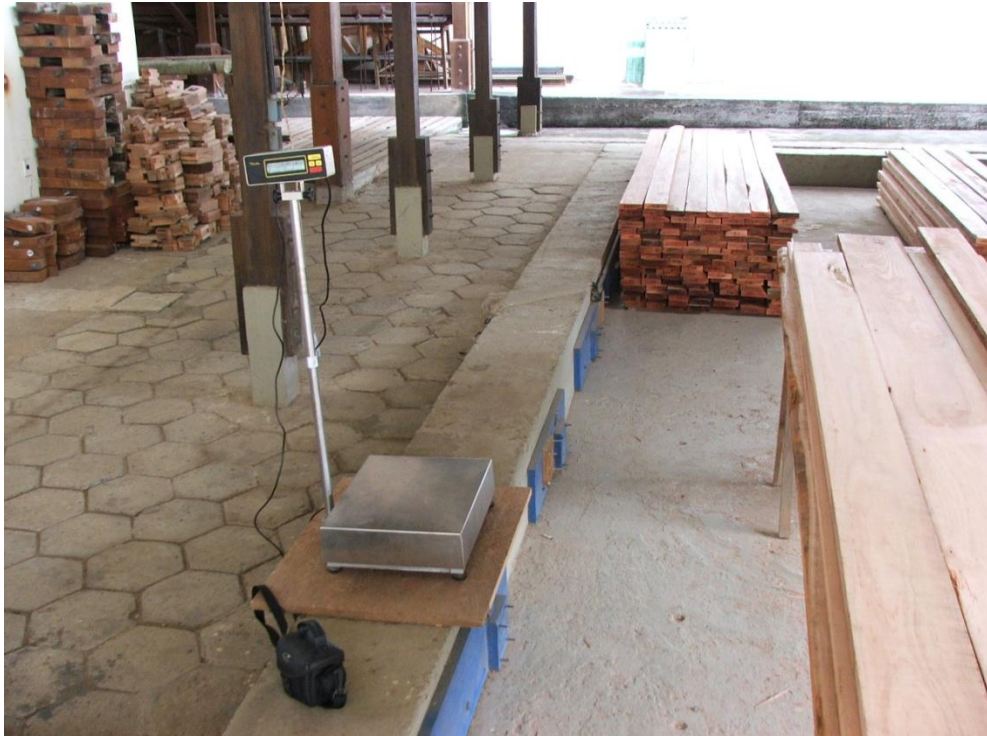
Figura 17 – Formação das pilhas de madeira e balança utilizada para pesagem das tábuas.
