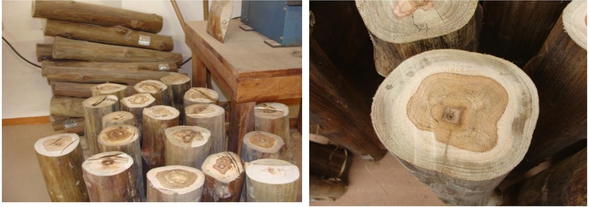
Figura 8. Seção transversal da madeira de *Tectona grandis* de diferentes idades, com diâmetros entre 9 e 13 cm.
