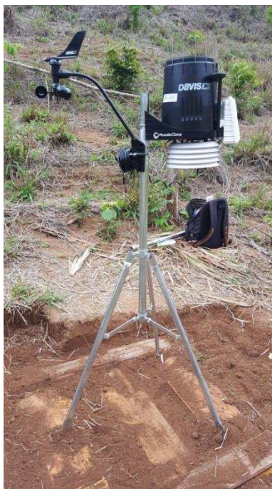
Figura 5. Estação meteorológica Davis Vantage Pro-2 utilizada na captação dos dados de chuva na microbacia em estudo.
