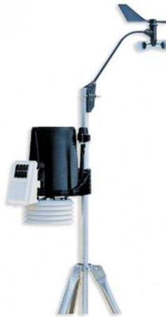
Figura 3. Estação meteorológica Davis Vantage Pro-2 (Fonte: Clima e Ambiente Soluções Meteorológicas 2 ).
