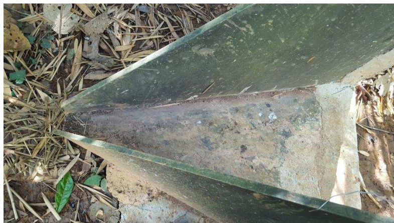
Figura 24. Calha “H” instalada a jusante da nascente da microbacia da bacia do Rio São Mateus, Itambacuri-MG, retratando a vazão ausente ainda no mês de agosto de 2017.
