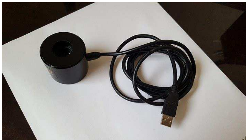
Figura 14. Cabo de transferência dos dados do levellogger e barologger para o computador.
