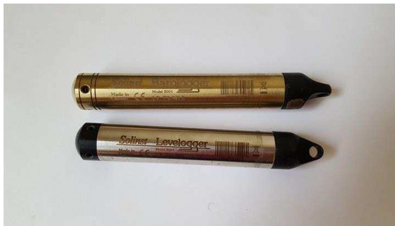
Figura 13. Medidores automatizados de nível de fluidos barologger e levellogger utilizados neste trabalho.
