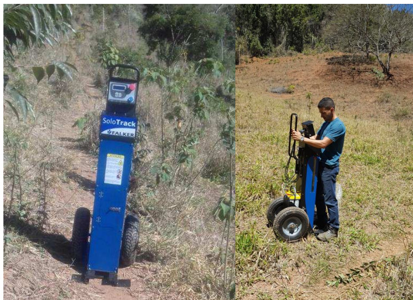
Figura 10. Equipamento Solo Track Falker e realização da resistência mecânica do solo à penetração.
