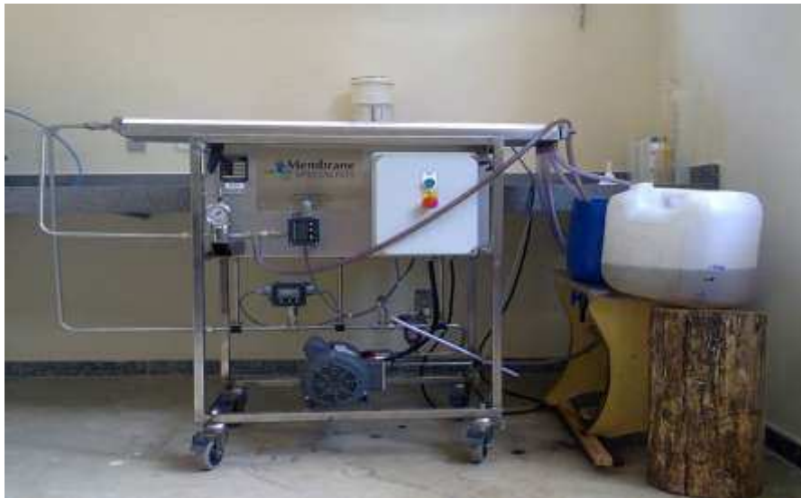
Figura 9. Equipamento empregado no tratamento por sistema de membranas.
