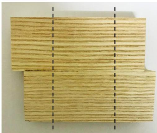
**Figura 14.** Corpo de prova da madeira *in natura* para ensaio de resistência ao cisalhamento na linha de soldagem.
