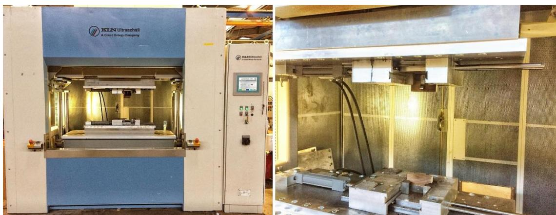
**Figura 13.** Máquina de soldagem de vibração LVW 2361 (Mecasonic, Annemasse, França).
