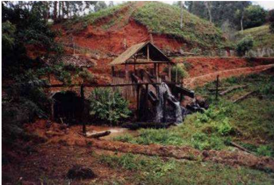
Figura 2B - Monjolo: engenho de milho no distrito de Bom Jesus do Madeira, município de Fervedouro-MG.
