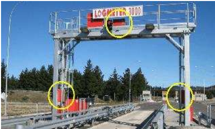
FIGURA 1 – Logmeter 4000 da Woodtech. Em destaque os scanners laser do sistema.
