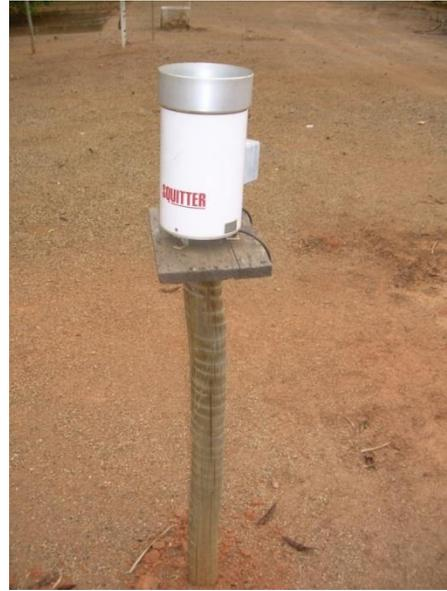
Figura 19 – Imagem do Pluviômetro e pluviógrafo instalados ao lado dos protótipos de coberturas, Viçosa, MG, 2013.
