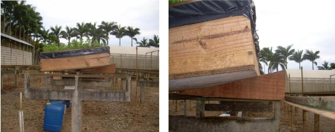
Figura 22 - Módulos de experimentação detalhando a inclinação de 15°, Viçosa, MG, 2013.
