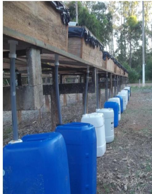
Figura 21 – Imagem dos recipientes e tubos coletores que iriam recolher a água escoada nos protótipos, Viçosa, MG, 2013.
