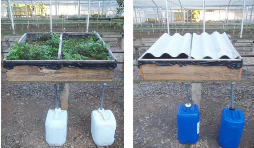
Figura 18 – Imagem dos módulos utilizados na experimentação, protótipo com cobertura viva e protótipo de cobertura convencional.
