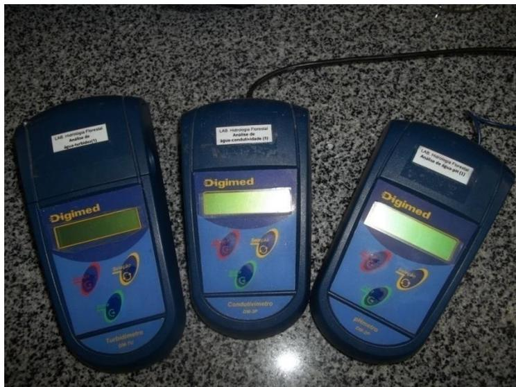
Figura 20 – Imagem do Turbidímetro, Condutivímetro, pHmetro utilizados para a análise da água, Viçosa, MG, 2013.
