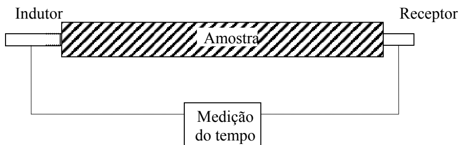
Figura 1 - Esquema de montagem de um teste de propagação de ondas de tensão.
