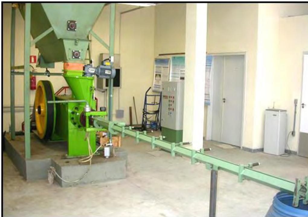
**Figura 27** – Briquetadeira industrial, tipo prensa pistão, utilizada na segunda fase do experimento.
