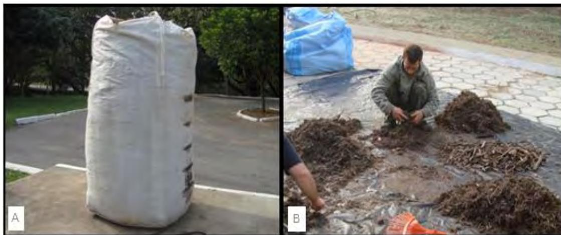
**Figura 52** – Recepção dos finos de madeira em sacos tipo “big bag” (A) e separação granulométrica após a secagem (ar livre) para quantificação da porcentagem de cascas e pedaços de madeira (B).
