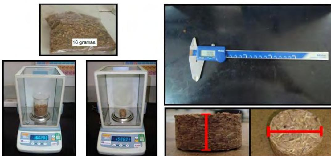
**Figura 23** – Avaliação da perda de massa antes e após a briquetagem e variação de altura e diâmetro dos briquetes.
