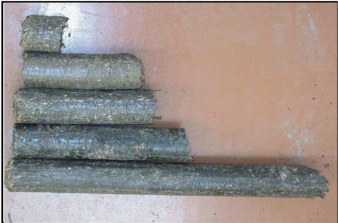
**Figura 54** – Foto dos briquetes (20 % lodo) cortados em diferentes tamanhos.
