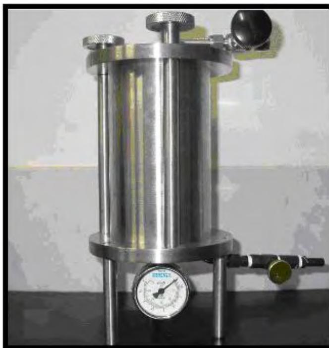
**Figura 16** – Extrator ZHE utilizado durante o ensaio de lixiviação do lodo biológico.
