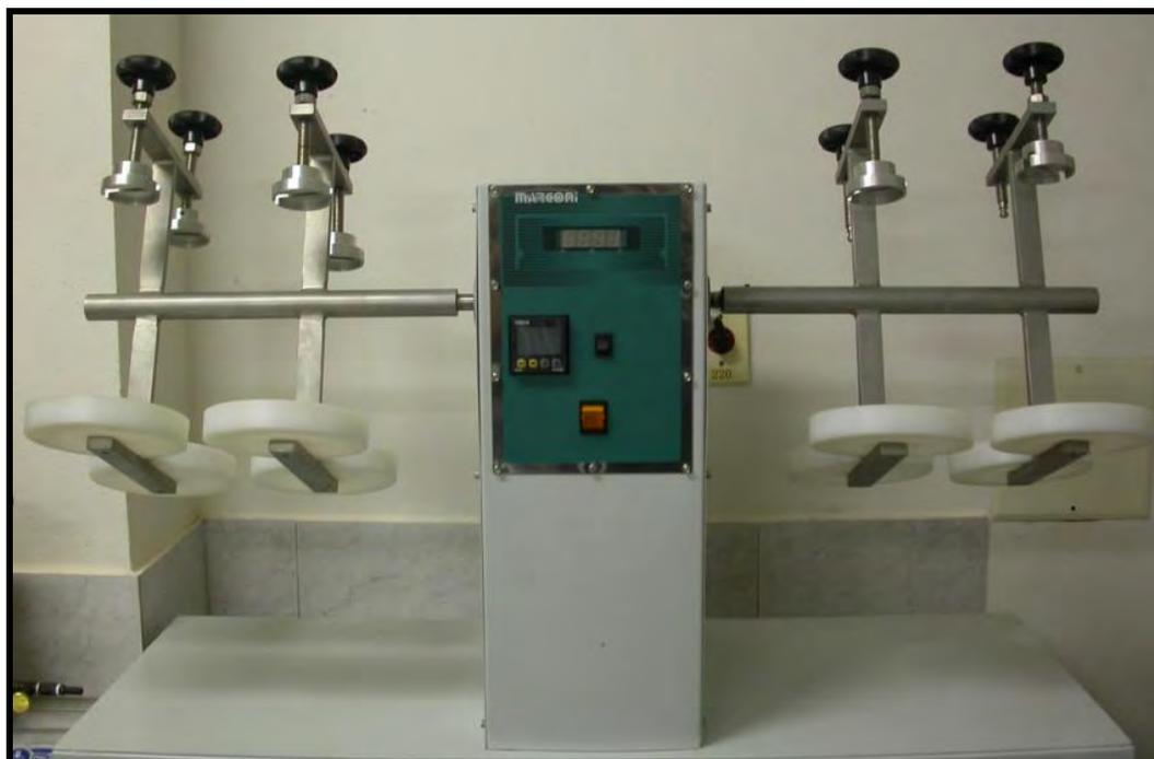
**Figura 17** – Agitador rotatório de frascos utilizado para análise de lixiviação do lodo biológico.
