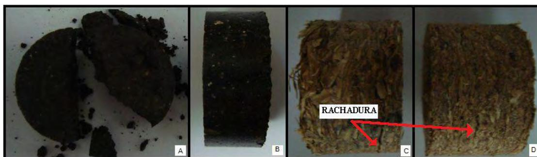
**Figura 44** – Briquete 100 % lodo após o teste de compressão (A), briquete 100 % lodo antes do teste de compressão (B), briquete 100 % finos de madeira após o teste de compressão (C) e briquete 100 % finos de madeira antes do teste de compressão (D).
