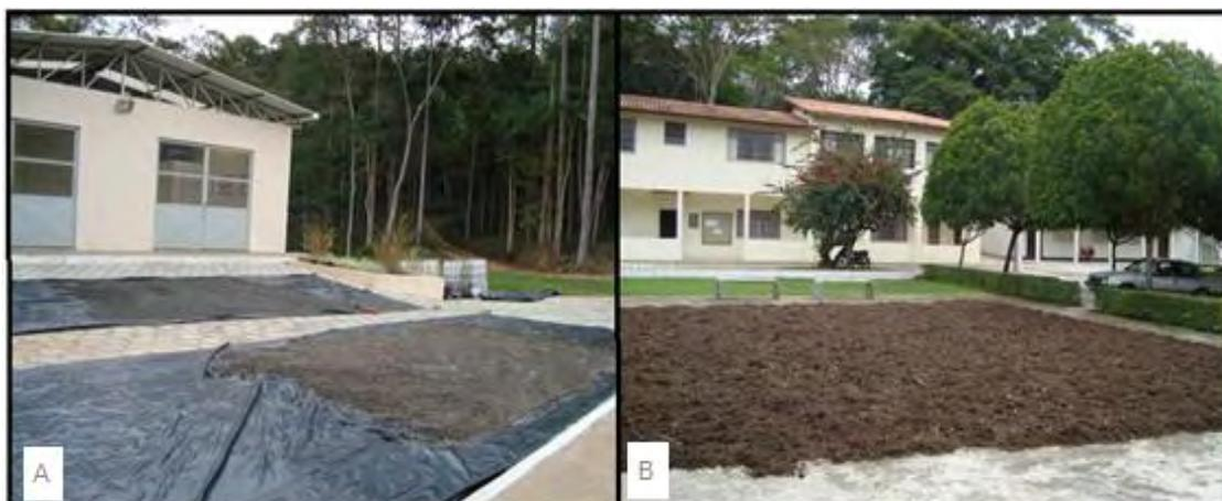
**Figura 51** – Secagem do lodo biológico (A) e a da biomassa (B) ao ar livre até atingir a umidade recomendada para a briquetagem.
