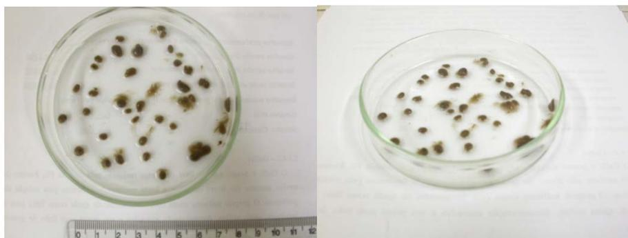
Figura 14 - Grânulos aeróbios obtidos a partir do tratamento de efluente de máquina de papel.
