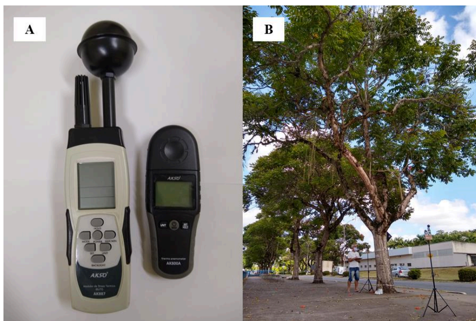
Figura 5. Medidor de estresse térmico AK887 e anemômetro digital AK800A (A); e os equipamentos instalados em campo (B).
