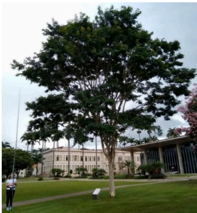
Figura 6. Medição da altura total da árvore utilizando uma vara graduada.
