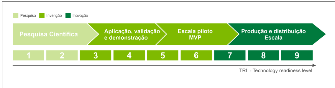
Figura 11 - Escala de maturidade da tecnologia - Fonte: Adaptado de NASA, 2015.
