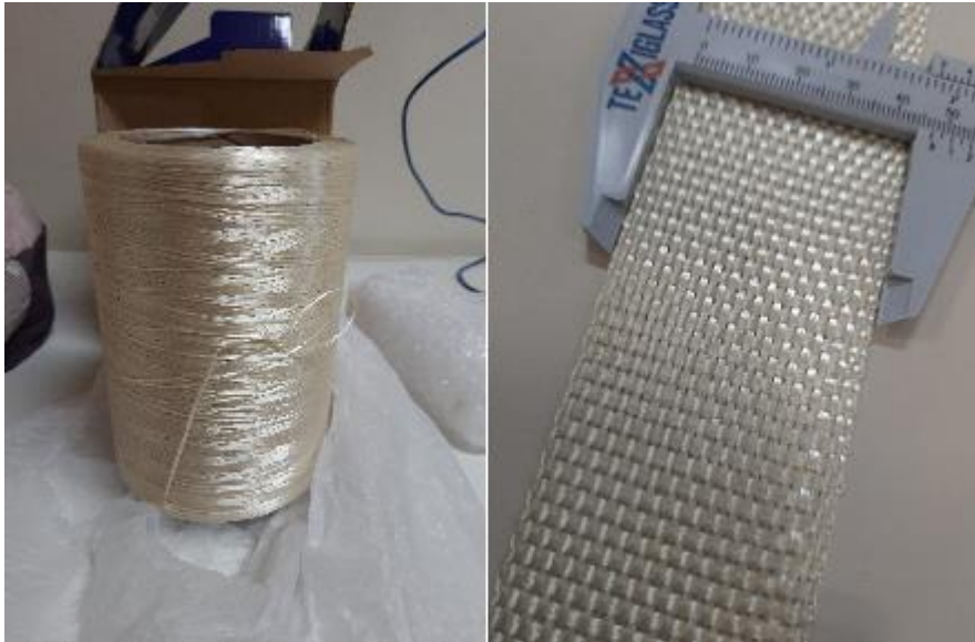
Figura 5 - Filamentos e tecido obtido de Vectran
