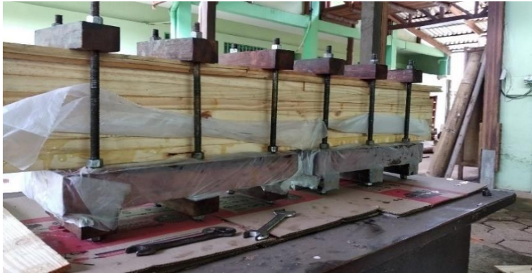
Figura 10 – Prensagem de elementos de madeira lamelada colada
