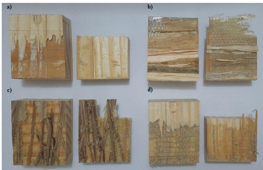
Figura 19 - Ruptura em corpos de prova de cisalhamento na linha de cola no sentido paralelo às fibras. a) Sem reforço; b) Vectran; c) Bambu; d) Juta
