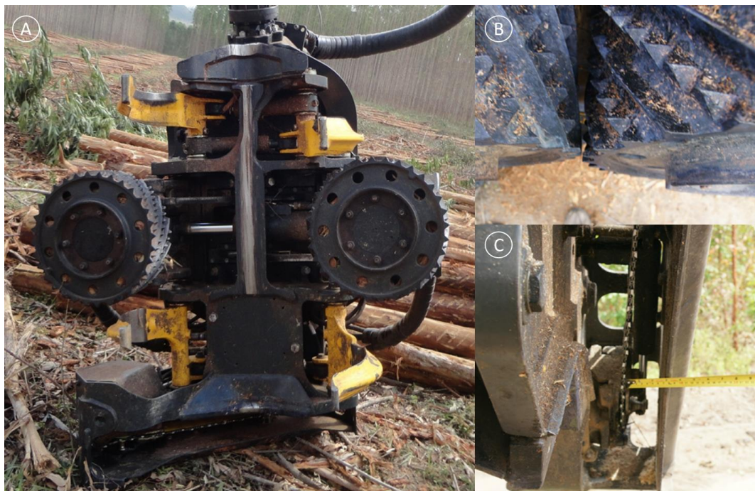
Figura 12: Exemplo de cabeçote de harvester visto frontalmente (A), distância entre os rolos (B) e a serra (C).
