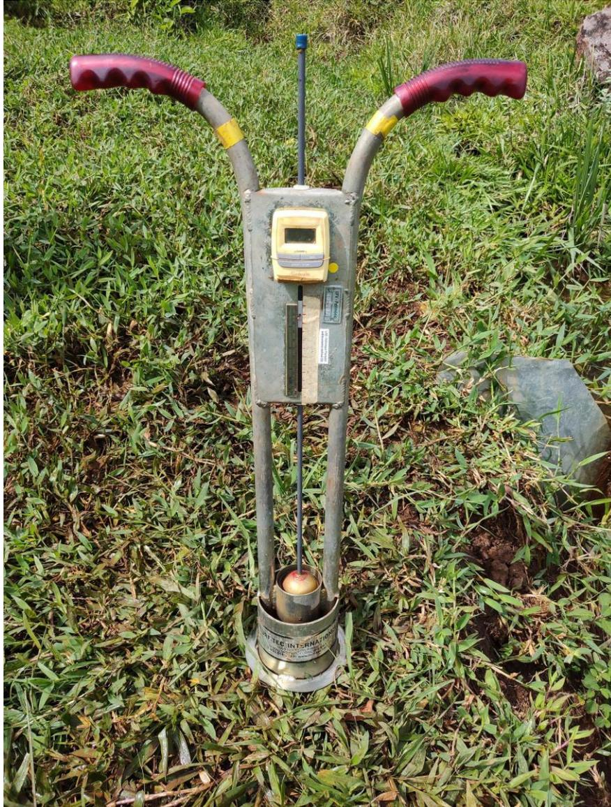
Figura 11 - Infiltrômetro Turf-Tec International do Laboratório de Hidrologia Florestal da UFV
