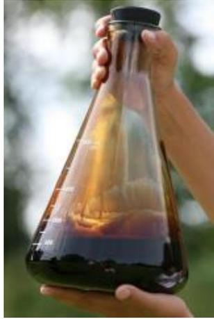
Figura 11. Bio-óleo obtido através do processo de pirólise de biomassa.
