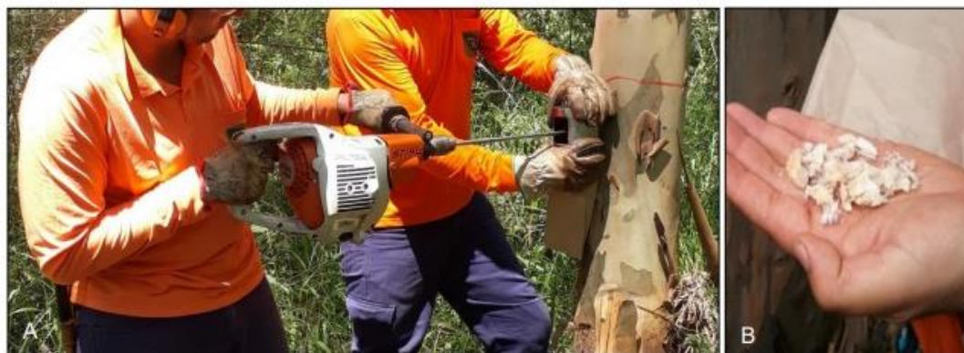
Figura 2. A: Processo de coleta em campo com o auxílio da furadeira com broca. B: Amostra de serragem coletada. Fonte: CMPC, 2020.
