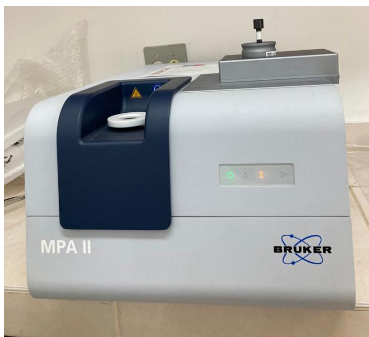
Figura 5. Espectrofotômetro MPA-II da fabricante Bruker. Fonte: autor.
