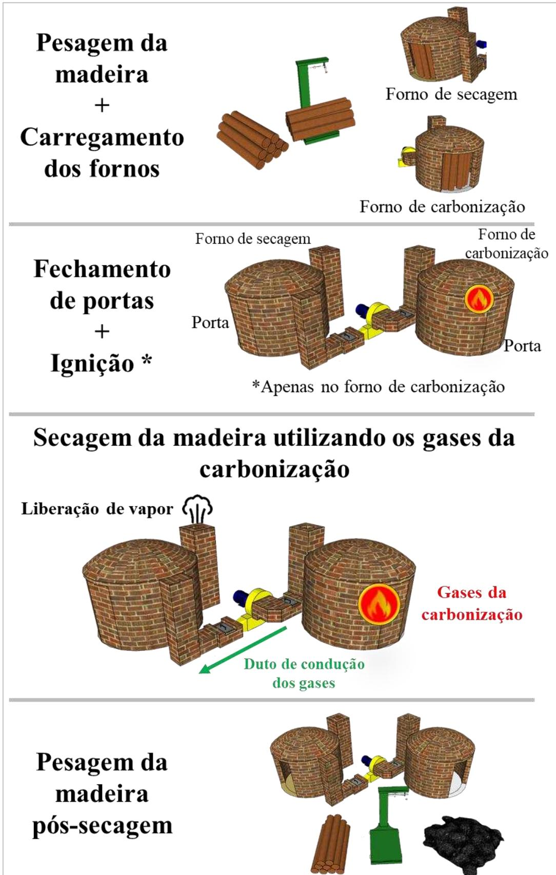
**Figura 3** – Fluxograma da 1ª Etapa do experimento – Secagem da madeira dentro do forno utilizando os gases da carbonização.
