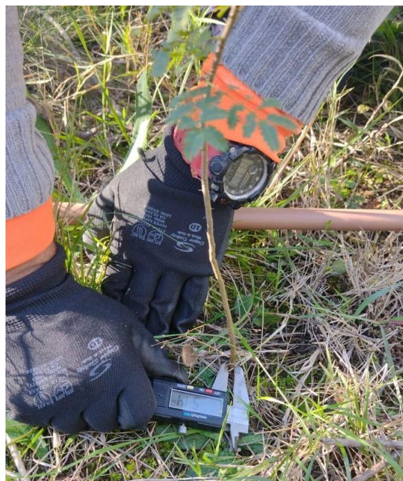
Figura 3 - Mensuração de diâmetro na altura do colo com auxílio de paquímetro digital para avaliação da regeneração natural em área de monitoramento de restauração em Rio Pardo, RS.
