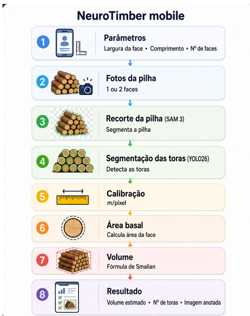
Figura 6.1. Fluxograma de funcionamento do NeuroTimber Mobile: coleta dos parâmetros (largura da face, comprimento da tora e número de faces), envio da(s) fotografia(s), segmentação e recorte da pilha por SAM 3, segmentação das toras por YOLO26, calibração métrica, cálculo da área basal, aplicação da fórmula de Smalian e devolução do resultado ao usuário.
